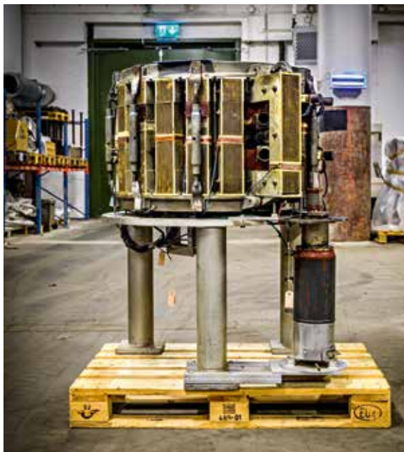
FÖRE: UrMAX från 1953. 1 265 kilo tung. Får plats på en lastpall. Upptar knappt en kvadratmeter.
